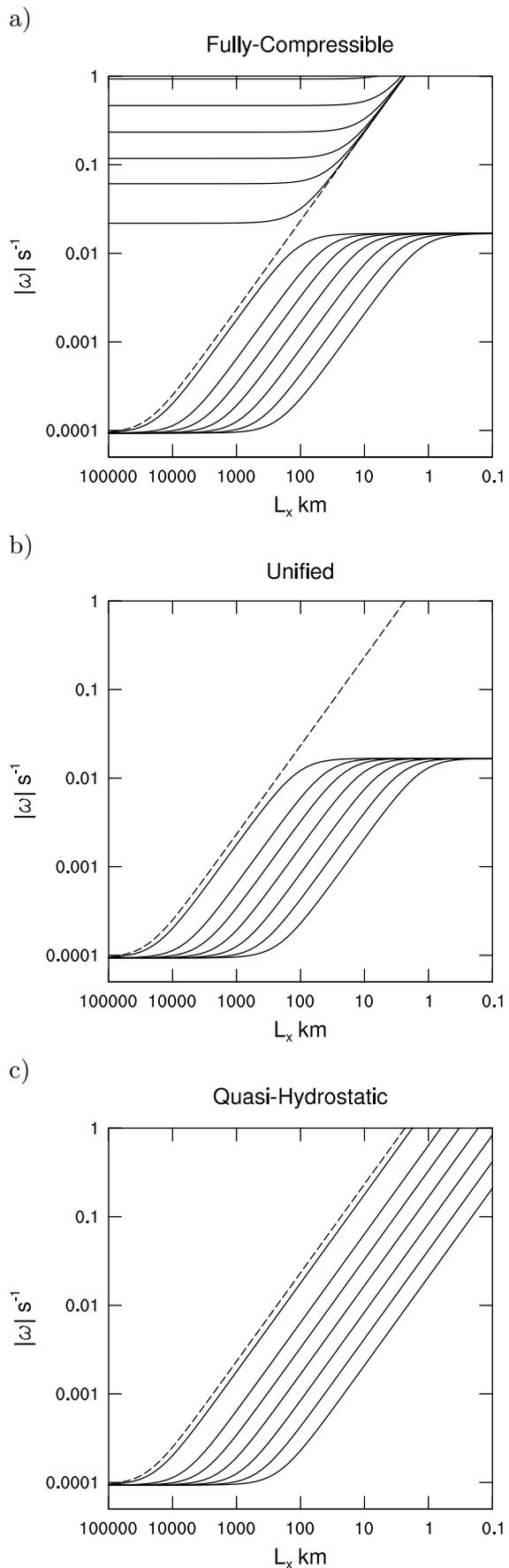
図 1: 等温大気を仮定し,  $f$  面上で求めた分散関係. a) 完全圧縮系, b) 統一系, c) プリミティブ系. Arakawa and Konor (2009) に基づき作成. 点線はラム波, 実線は, 右下が重力波, 左上が音波.
